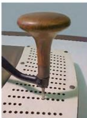
Slika 6. Izrada bušene kartice (Izvor: Element, 2023)
