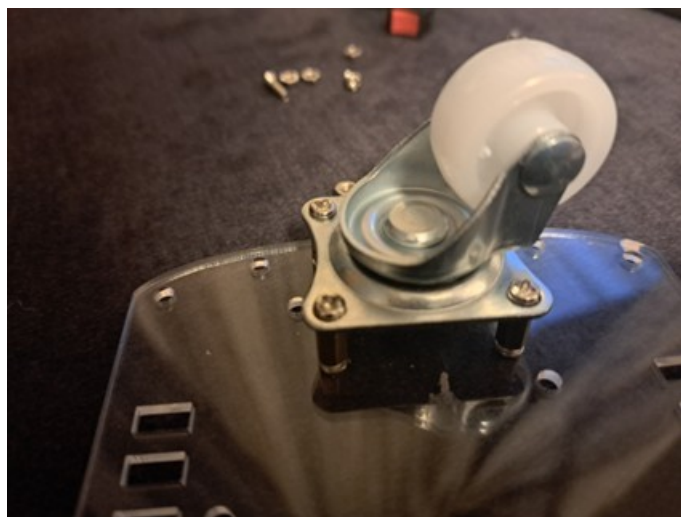
Slika 11. Montaža kugličnog kotača na šasiju
