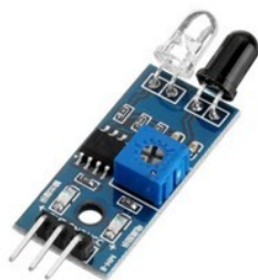
Slika 3. Infracrveni detektor prepreka (Diykits.eu 2024.)
