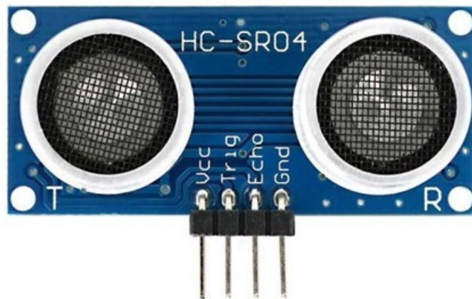
Slika 4. Ultrazvučni daljinomjer HC-SR04 (Diykits.eu 2024.)
