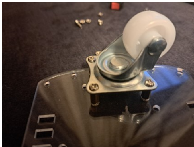
Slika 11. Montaža kugličnog kotača na šasiju
